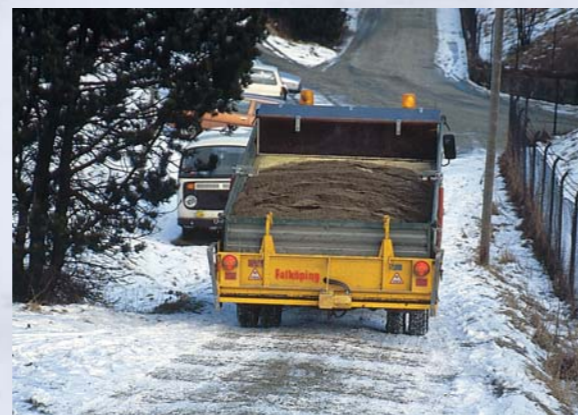
B-2H är i standardversion utrustad med två uppfällbara stödben
